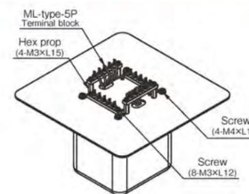
取付面の底板には、ねじ穴(M3)を12ヶ所設けてあります。引出しリード線の配線・接続をする際、シャーシ切抜き図のような穴を必要な個所に開けて頂くと、左図のように端子台を取り付ける事が出来ます。端子台取付ネジ長さは12mm以下です。
