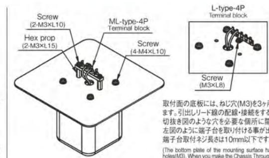
取付面の底板には、ねじ穴(M3)を3ヶ所設けてあります。引出しリード線の配線・接続をする際、シャーシ切抜き図のような穴を必要な個所に開けて頂くと、左図のように端子台を取り付ける事が出来ます。端子台取付ネジ長さは10mm以下です。
